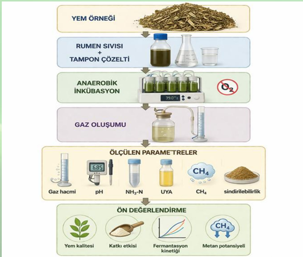
Şekil 1. Kesikli gaz üretim sisteminin şematik gösterimi.
